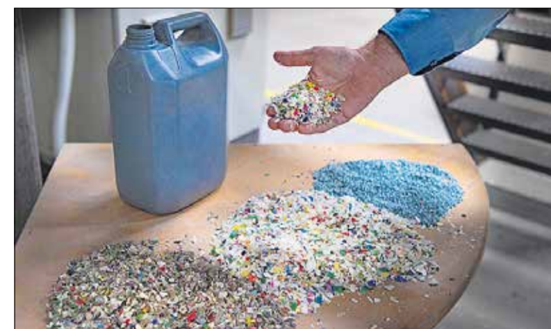
Det sorterede plastaffald skal igennem flere maskiner og faser, inden det kan bruges igen. Bunken yderst til venstre er det kværned plast, som det ser ud, før det kommer i den nye maskine "Georg". Bunken i midten har været en tur igennem Georg, og bunken yderst til højre er det færdige granulat.
