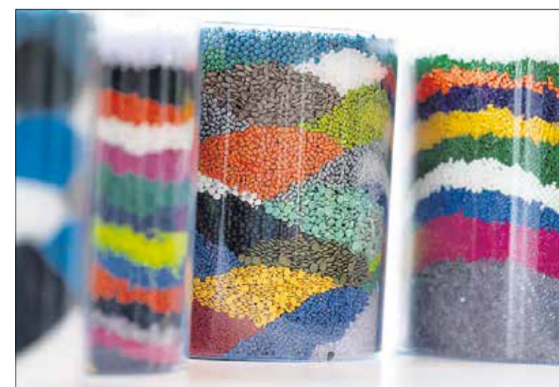
Det færdige granulat, som kan bruges til at lave nye plastprodukter af, kan laves i mange farver ved at tilsætte farvestof.
